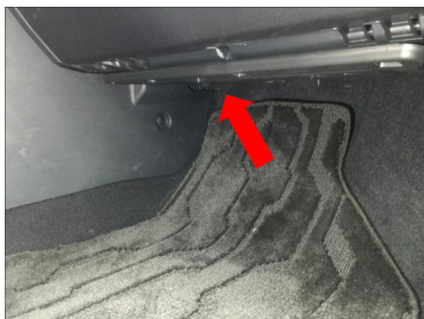
正极布线：在副驾驶室（箭头）处卡扣拆下，然后把装饰板拆下，
