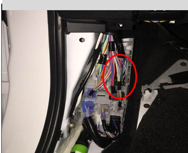
接信号线 在驾驶室左下角内侧边缘位置找到箭头处线束盒子；
