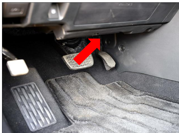
右踏板电机布线：穿过此孔延伸至副驾驶位。（箭头）
