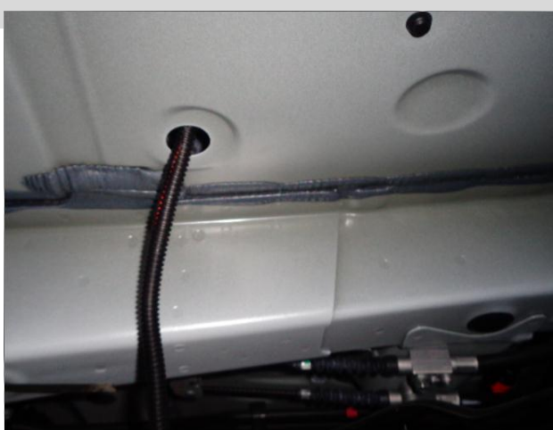
左踏板电机穿线孔：把车底胶塞卡进电机线上，穿线后在孔周边打防水胶，外露的线用扎带固定
