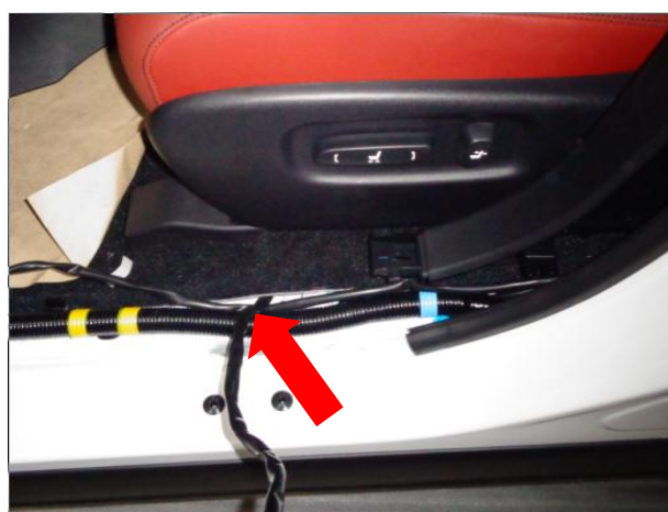
左踏板电机穿线孔：左电机线穿线孔对应位置（箭头），左右两边踏板电机穿线孔方法一致；
